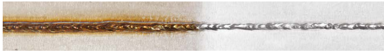
Soldadura WIG con dos pasadas
